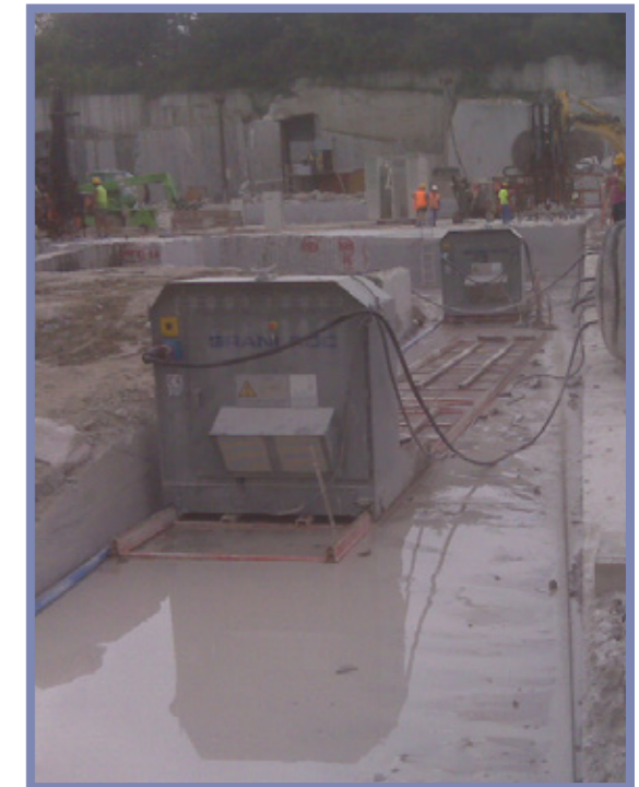
Máquinas CBC 100 C.V. de Grani Roc en una cantera de granito en Francia. Sendos cortes horizontales de 400 m2.
